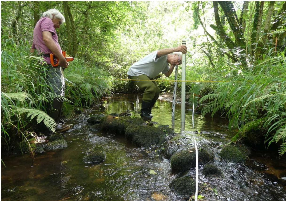
Figure 1 : Mise en œuvre du protocole ROHZACE par 2 opérateurs (© OFB).
