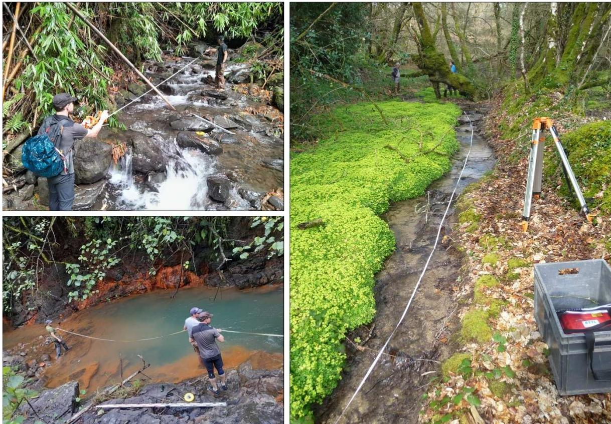
Figure 6 : La disposition d'un décamètre au long de la station permet de déterminer ses bornes amont et aval, et permettra également de repérer la position et de faciliter différentes mesures intégrant le périmètre du protocole ROHZACE (profils en travers, faciès, habitats aquatiques complémentaires, etc.). (© OFB)
