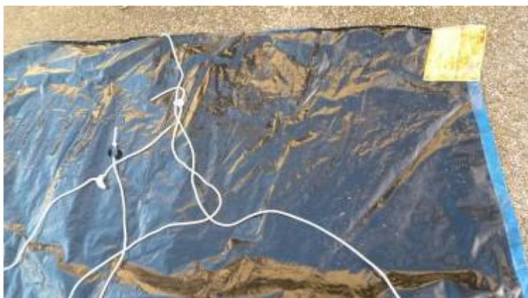
Etat du parefouling, côté intérieur, après un nettoyage au jet haute pression.
