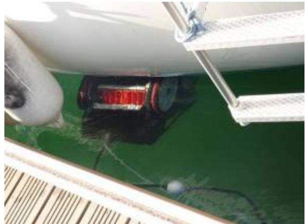
L'Hulltimo pro dispose d'une brosse rotative articulée à l'avant et de deux brosses rotatives sous le robot.
