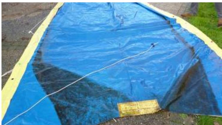
Sur le côté extérieur du parefouling, on voit que la partie arrière n'était pas correctement ajustée et que cela a occasionné un développement de fouling.
