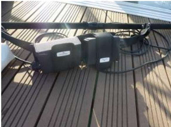
Batteries se portant à la ceinture pour alimenter le robot Hulltimo smart.
