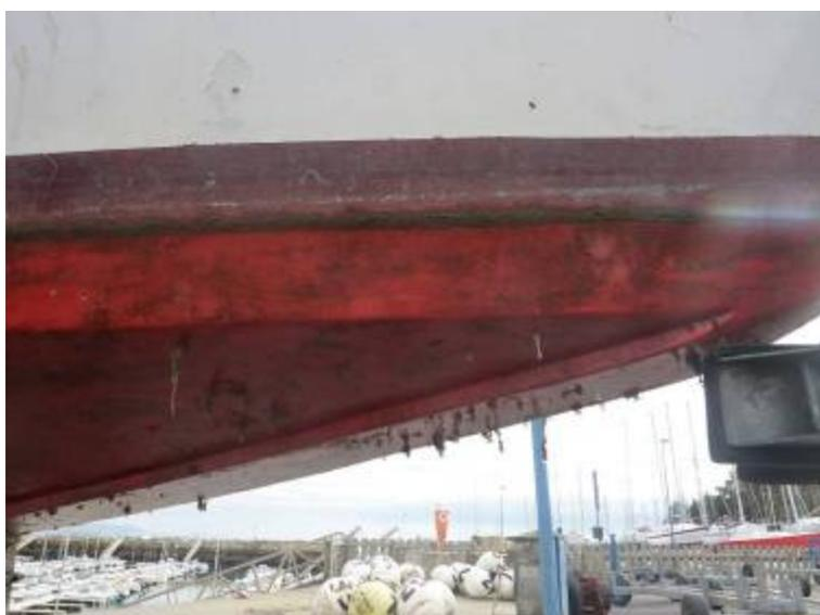
Le bateau a été gruté hors de l'eau le 18 novembre après six mois de test. Le constat est que des algues vertes se sont développées au niveau de la ligne de flottaison et des algues rouges ou brunes dessous la carène et sous la quille principalement. La coque est recouverte d'une pellicule de fouling qui s'enlève très facilement. La seconde constatation non négligeable est l'absence de mollusques sur la carène ou encore de balanes.
