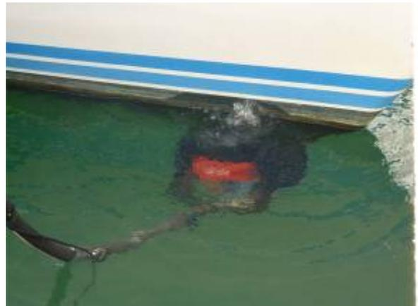
Le robot se plaque contre la carène et se dirige à l'aide de perches soit à partir du ponton, soit à partir du pont du bateau.
